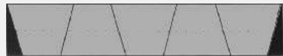
Corte de un sector de la placa para correas de cuerda central
